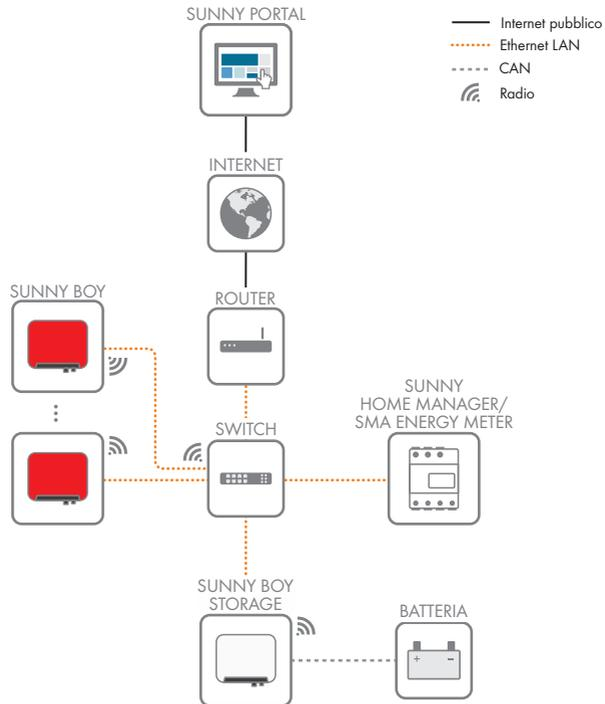
Figura 4: Struttura della comunicazione dell'impianto
