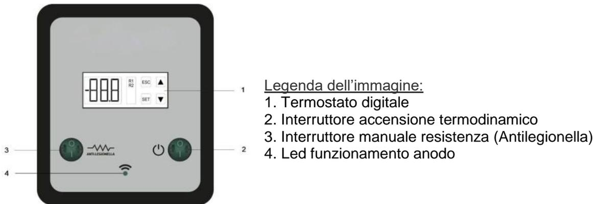
Una volta verificate tali indicazioni, accendere il sistema termodinamico premendo il pulsante destro (Tasto n°2) L'interruttore della resistenza elettrica (Tasto n°3) deve restare disattivato.
