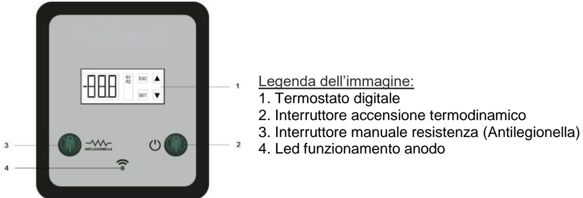
Una volta verificate tali indicazioni, accendere il sistema termodinamico premendo il pulsante destro (Tasto n°2) L'interruttore della resistenza elettrica (Tasto n°3) deve restare disattivato.
