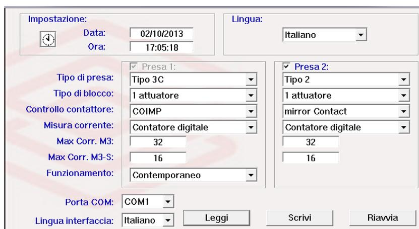
L'utente può anche verificare la configurazione della stazione installata, visualizzando i dati settati in fabbrica, mediante il comando **Leggi**; i campi possono assumere i seguenti valori:
