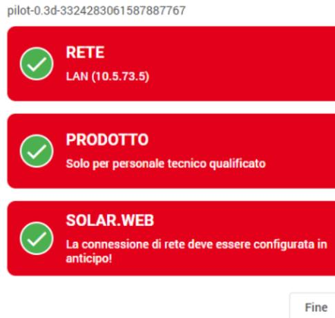
Qualora abbiate impostato il setup paese errato, per correggerlo bisognerà entrare sul menù requisiti di sicurezza e di rete e successivamente su selezione specifico del paese con il codice **77634**:
