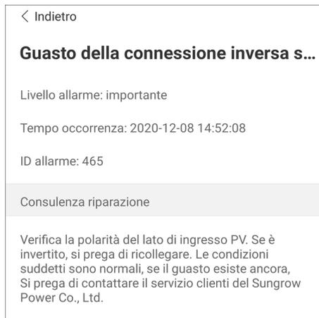
Figura 7-9 Informazioni dettagliate sull'allarme errore
