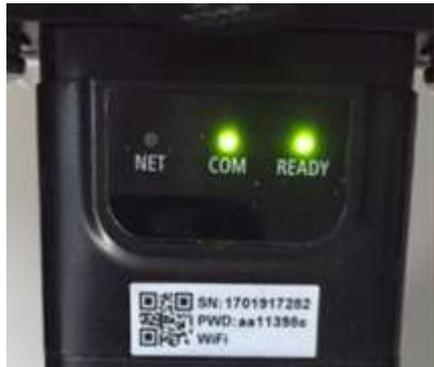
Figura 59 – Stato di comunicazione irregolare tra scheda e server remoto
