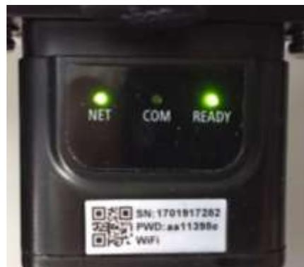
Figura 58 - Stato di comunicazione irregolare tra inverter e scheda
