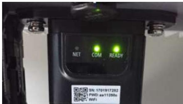
Figura 56 - Stato iniziale dei led
