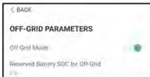
**Figura 8-16** Parametri off-grid
