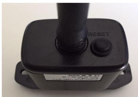
Figura 61 – Pulsante Reset sull'adattatore Wi-Fi
