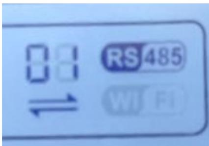
Figura 88 - Simbolo RS485 sul display dell'inverter
