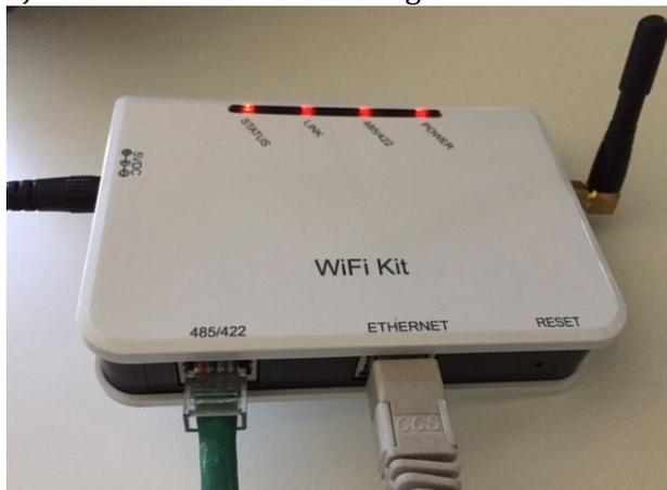
Figura 89 – Cavo Ethernet collegato al datalogger
