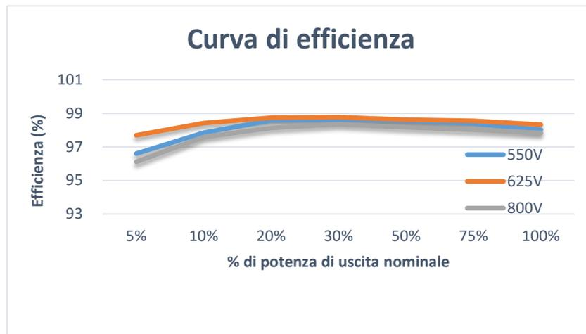
Figura 10 - Curva di efficienza della potenza (ad es., 80 kW)
