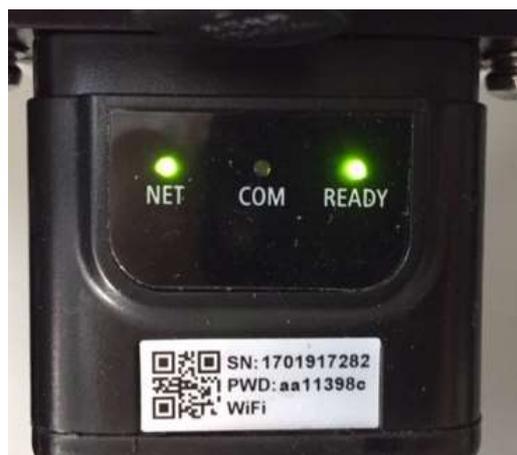
Figura 110- Stato di comunicazione irregolare tra inverter e scheda
