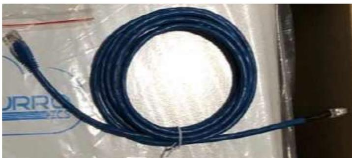
Figura 29 - Cavo di comunicazione fra inverter e batteria WeCo 5k3
