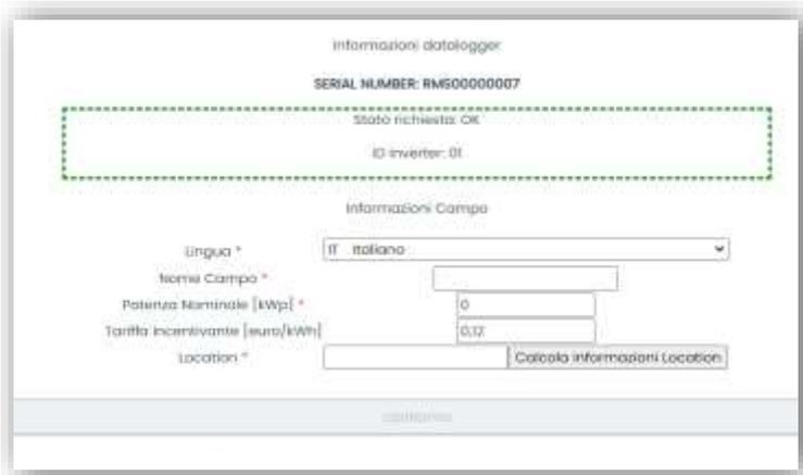
Una volta inserita la “location”, dove è situato il campo, è necessario premere sul pulsante “Calcola informazioni Location”, per permettere al sistema di ricavare latitudine, longitudine e timezone dell’impianto. Al termine bisogna quindi premere sul pulsante “conferma” per portare a compimento la configurazione del proprio campo. Basterà attendere alcuni minuti per poter osservare il flusso di dati sul portale ZCS Azzurro.
