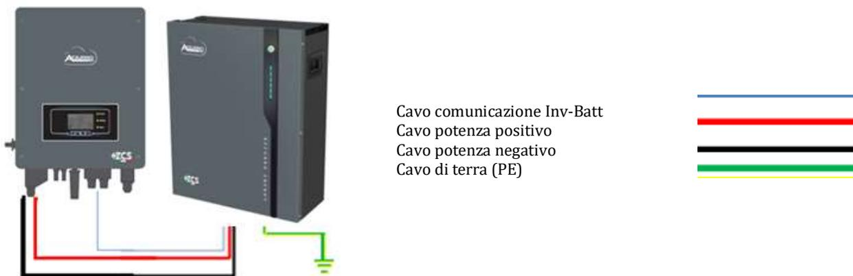
Figura 37 - Connessione batteria AZZURRO 5000
