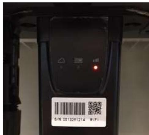
**Figura 101 – Stato di comunicazione irregolare tra wifi e server remoto**
