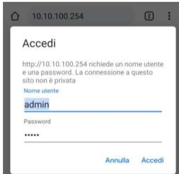
Figura 87 – Schermata di accesso al web server per la configurazione della scheda wifi
