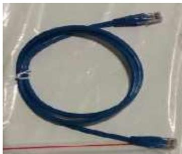
Figura 40 – Cavo di comunicazione fra batterie AZZURRO 5000
