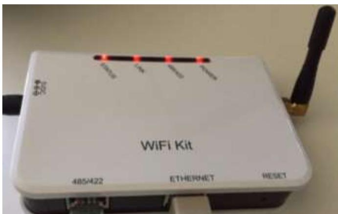
Figura 139 – Led che indicano la corretta configurazione del datalogger
