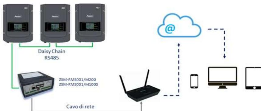
Figura119 - Schema di funzionamento del datalogger ZSM-RMS001/M200 / ZSM-RMS001/M1000
