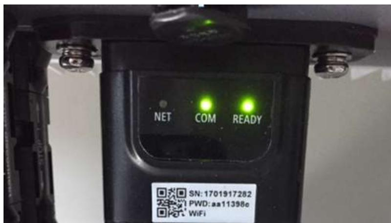
Figura 108 - Stato iniziale dei led
