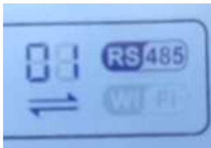
Figura 125 - Simbolo RS485 sul display dell'inverter
