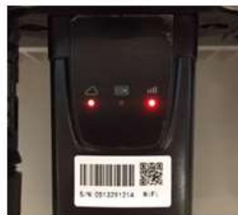
Figura 99 - Stato di comunicazione irregolare tra inverter e wifi
