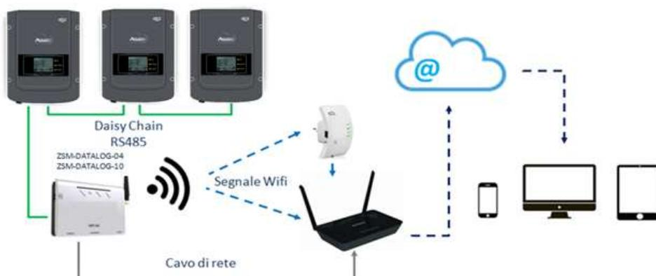
Figura 118 - Schema di connessione del datalogger ZSM-DATALOG-04 / ZSM-DATALOG-10
