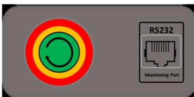
Figura 73 - Vista pulsante di accensione batteria WeCo
