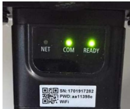
**Figura 117 – Stato di comunicazione irregolare tra scheda e server remoto**
