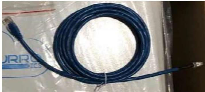
Figura 36 - Cavo di comunicazione fra inverter e batteria AZZURRO 5000
