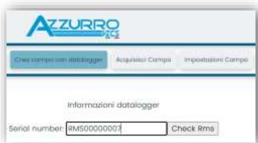
Inserire il serial number (S/N) del datalogger di riferimento e premere sul tasto “check RMS”. Se il datalogger è stato configurato in maniera corretta, si aprirà una schermata dove si dovranno inserire le informazioni richieste relative al campo da installare.
