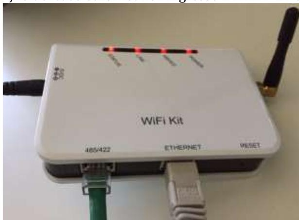
Figura 126 - Cavo ethernet connesso al datalogger
