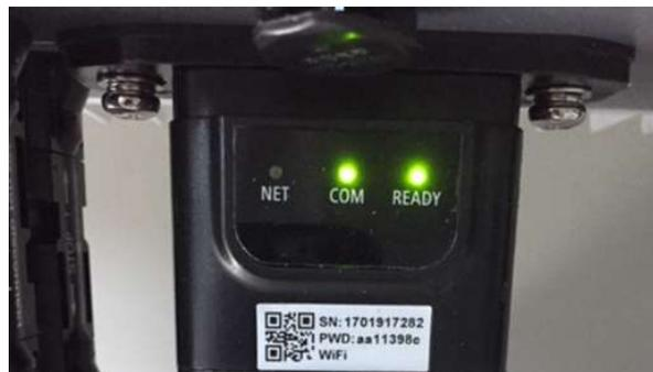
Figura 114 - Stato iniziale dei led
