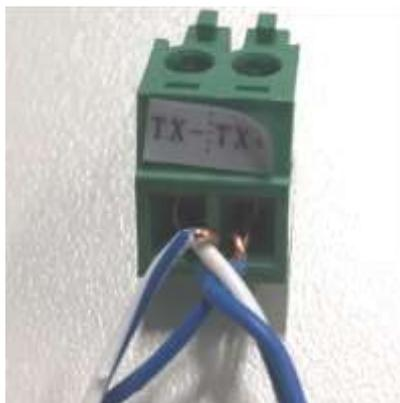
Figura 121 - Serraggio del cavo di rete sul morsetto RS485
