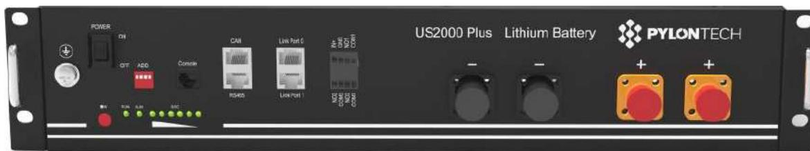
Figura 72 – Stato della batteria dopo aver posizionato lo switch POWER su ON ed aver premuto il tasto SW
