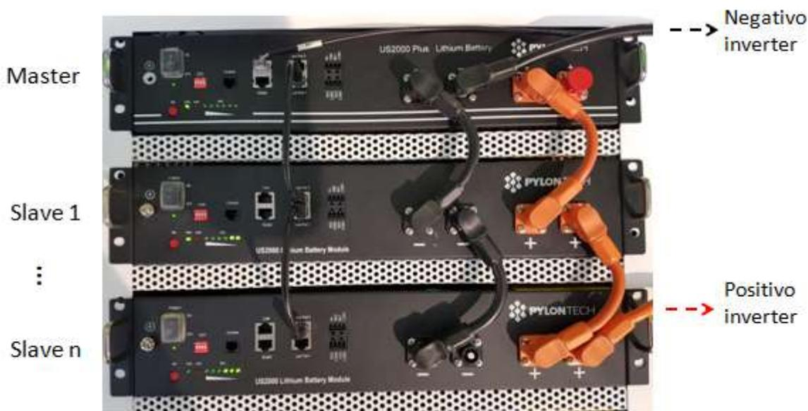
Figura 11 - Parallelo di tre batterie Pylontech
