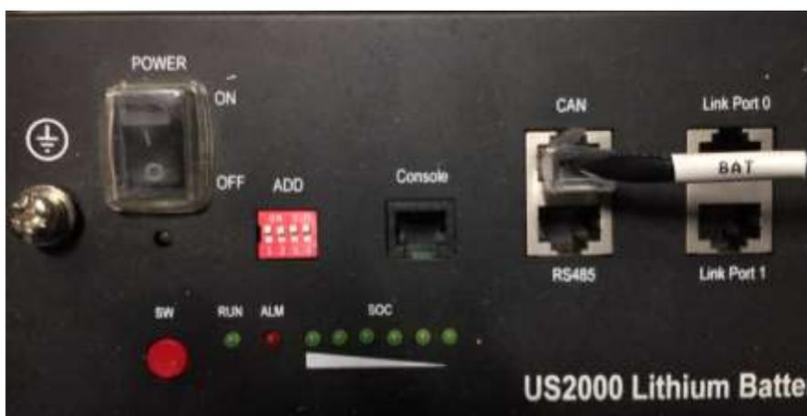
Figura 12 - Connessione cavo di comunicazione sulla batteria Pylontech
