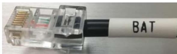
Figura 11 - Cavo di comunicazione Pylontech plug da inserire nell'ingresso comunicazione batteria
