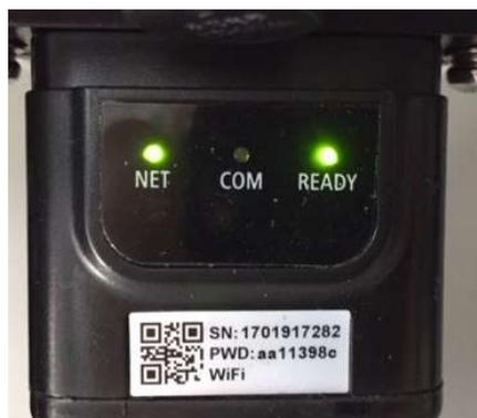
Figura 116 - Stato di comunicazione irregolare tra inverter e scheda
